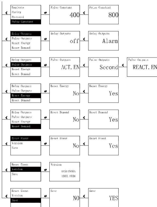
System parameter setting and communication parameter setting:
